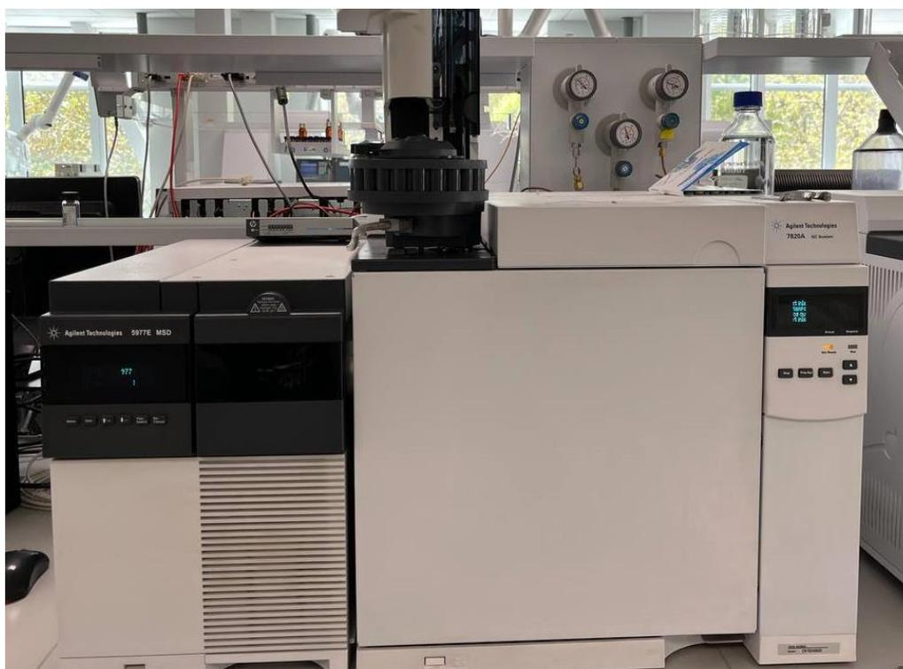
Рисунок 3 - Газовый хроматограф с масс-спектрометрическим детектором 7890А/5975С
